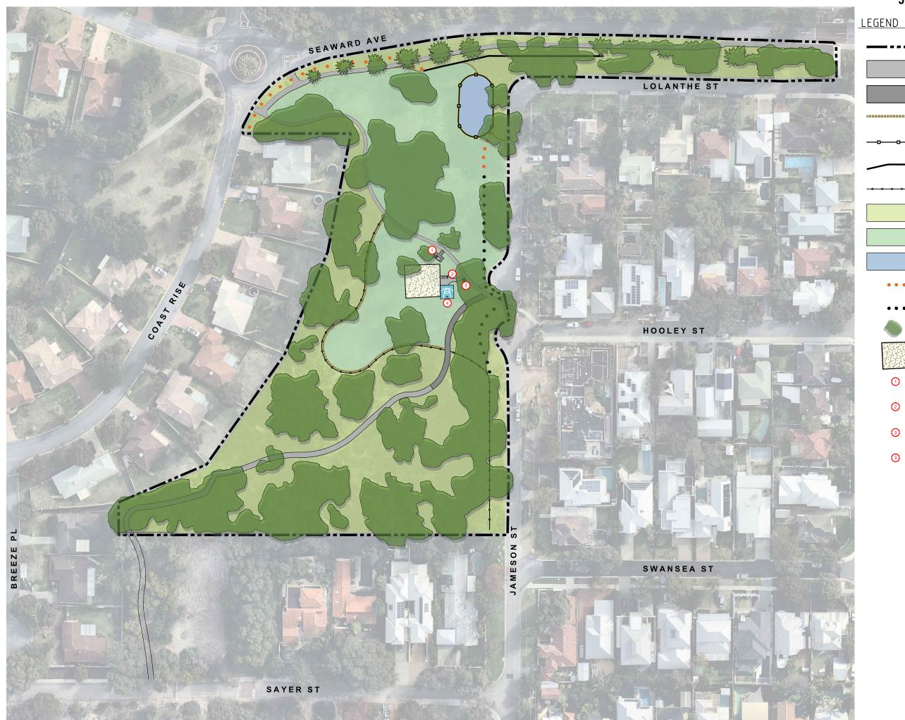
EXTENT OF WORKS EXISTING FOOTPATH PROPOSED FOOTPATH \*\*\*\*\*\*\*\*\*\*\*\*\*\*\*\*\*\* CONCRETE EDGE NEW FENCE ON BLOCK WALL EXISTING RETAINING WALL BUSHLAND CONSERVATION FENCING ECO-ZONE (MULCH & NATIVE PLANTING) CASUAL USE TURF INFILTRATION ZONE PROPOSED BOLLARDS EXISTING BOLLARDS EXISTING CANOPY EXISTING PLAYGROUND & BINS BBQ ON CONCRETE PAD DRINK FOUNTAIN DOG WASTE STATION
